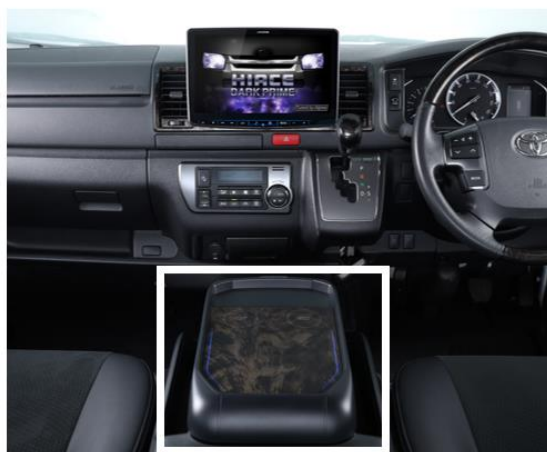
スマートフォンを置くと充電が開始され コンソールに表示が出現する
